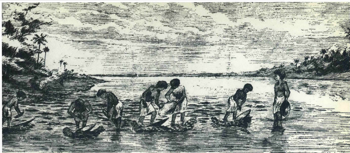
Enkel form av guldvaskning i Colombia: »River bar washing.» — Efter Bullman i Eng. Min. Jour. 53, 1892.
