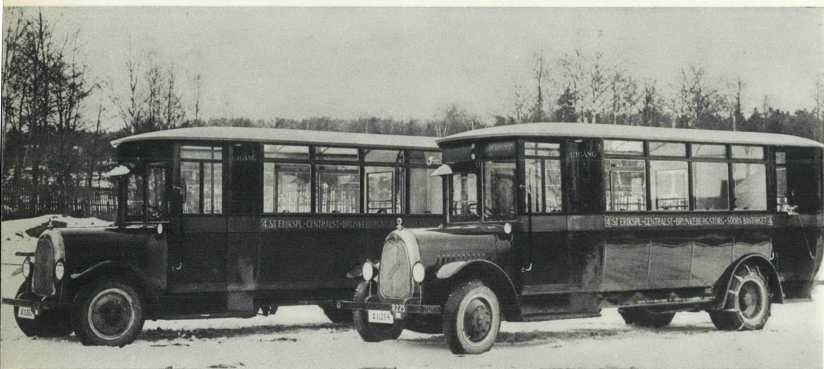
Ovan. En av de första bussleveranserna till Stockholms Spårvägar ägde rum 1927. Bussarna hade 4-cyl. 50 hk motor och tog 26 passagerare. Nedan. Tidaholmsbuss från 1930.
