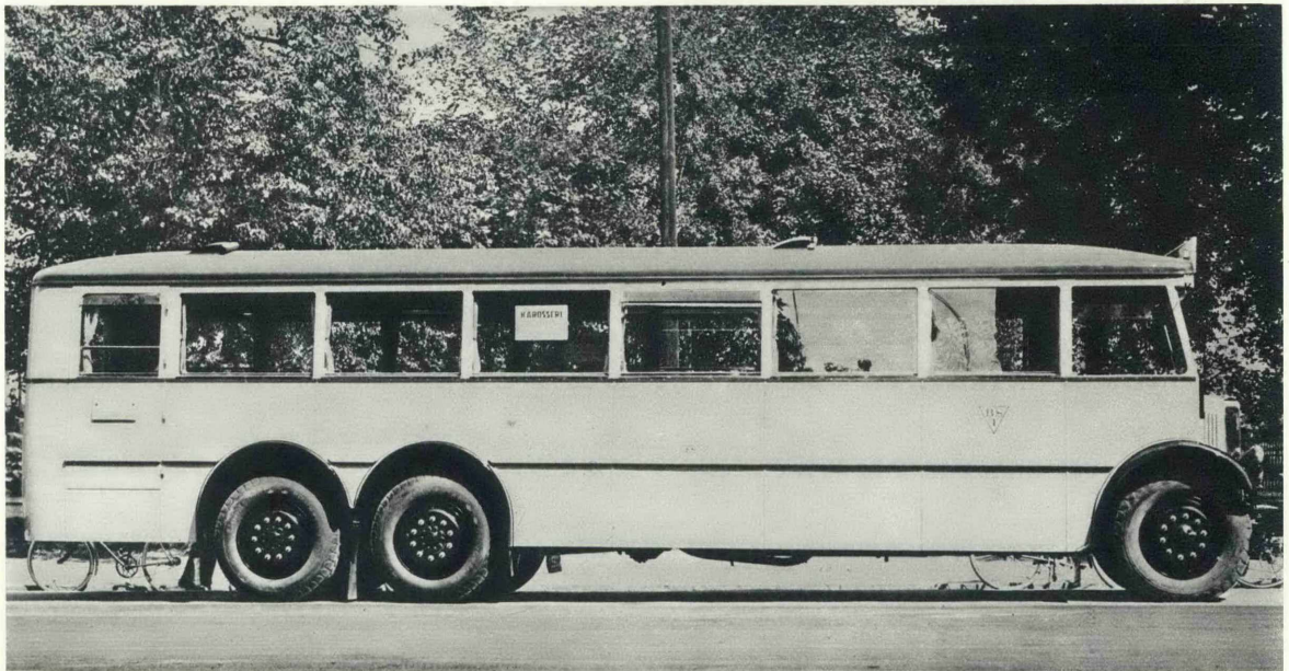
Treaxlad buss med drivning på båda bakre hjulparen. Den tog 46 passagerare och levererades 1931 till Brännkyrka—Södertörn Trafik AB.
